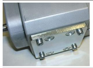
Für Lucas Anwendungen besitzt das Gerät eine am Boden befestigte Adapterplatte, die die Welle auf die korrekte Höhe von 44,6mm bringt und der Aufnahme der 4 Haltedübel dient.
