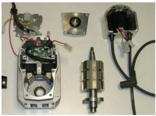
Es gibt keinen Grund das Gerät (über die Abnahme des Zündspulendeckels zum Zwecke der Zündeinstellung hinaus) zu öffnen. Außer der Sensoreinstellung befindet sich keine Serviceposition im Gerät.
