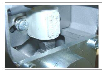
Sie werden den grauen Sensor für die Impulsgebung und unter diesem (verdeckt hinter der Lagerschale) den Rotor mit seinen 1 oder 2 Geberfingern erkennen.
