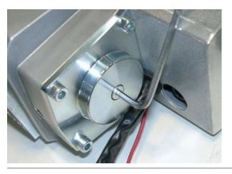
Am Ende der Welle ist eine Imbusschraube eingeklebt. Mit einem 3mm Imbusschlüssel läßt sich so die Welle leichter drehen und festhalten.
