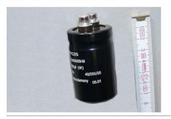
Nicht enthalten, aber bei Betrieb ohne Batterie notwendig ist ein Glättungskondensator. Er wird anstelle der Batterie eingebaut und so angeschlossen, als wäre er die Batterie. Der Kondensator hat 2 Schraubanschlüsse. Einer deutlich markiert mit + für das Pluskabel, der andere für den Anschluß zur Masse.
