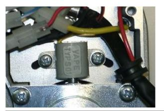
Da eine genaue Einstellung nicht immer einfach ist (das verhindert oft schon die Länge der Glieder der Steuerkette) und sich der Rotor zudem bei diesem Gerät wegen der starken Magnete nicht genau in jede Position setzen lässt, sondern seitlich wegzieht, ist eine nachträgliche, recht erhebliche Nachjustierung über eine seitliche Verschiebung des Sensors möglich.
