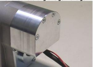
Entfernen Sie die 4 Senkkopfschrauben an der hinteren oberen Abdeckung (nicht die 4 unteren Imbusschrauben).
