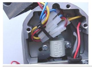
Wann immer Sie das Zündspulengehäuse auch geöffnet haben, stellen Sie immer sicher, daß alle Kabel gesichert sind und nicht zufällig in Kontakt mit dem Rotor gelangen können. Benutzen Sie einen Kabelbinder zur Befestigung.
